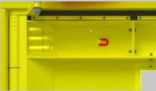
Die Überlastsicherung sorgt bei zu hohem Druck auf die Tür dafür, dass sie sich öffnet. So wird die Tür nicht beschädigt, wenn z.B. ein Auto davor fährt.
